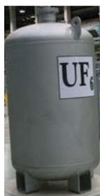
Рис. 1. Контейнер для транспортировки ГФУ объемом  $1 \text{ м}^3$ .
