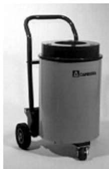
Рис. 3. Счетчик нейтронных совпадений JCC-51
