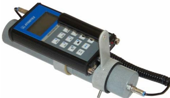
Рис. 7. Портативный многофункциональный сцинтилляционный гамма-спектрометр MKS-AT6101
