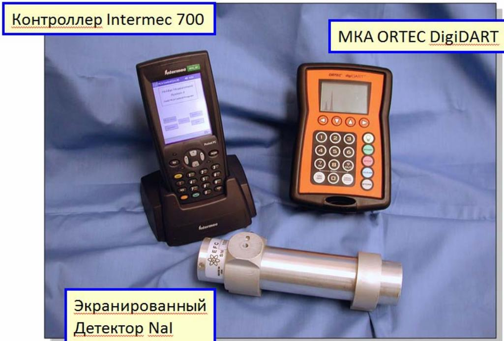
Рисунок 1. Компоненты базового комплекта системы HMS-4.
